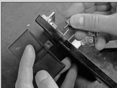
Namestitev izbrane plošče za rezanje
